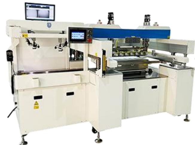
**IC-60-LTCC厚膜印刷机**
